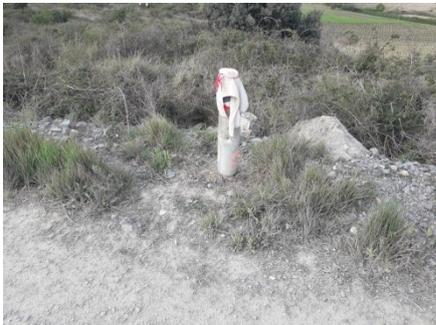
Figure 19 : Fiche piézomètre SPI
