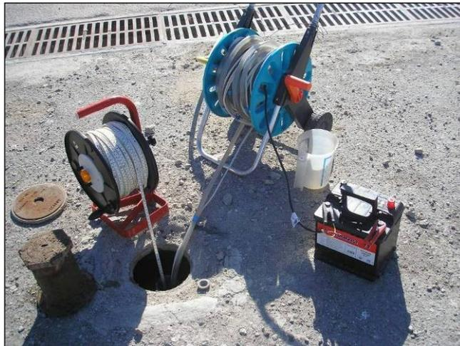
Photo 34 : Matériel de prélèvement des eaux souterraines
