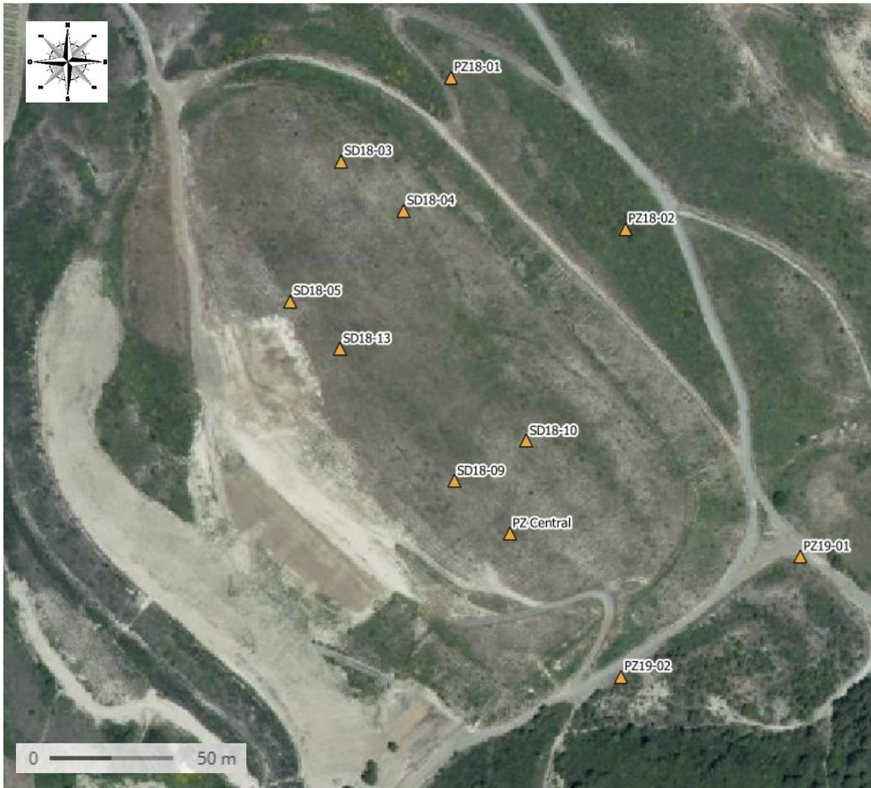
**Figure 68 : implantation des piézomètres de surveillance de Montredon durant les travaux**
